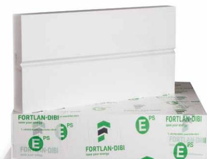
Pannelli isolanti in **Polistirene Espanso Sinterizzato** ottenuto da blocco, a celle chiuse, isotropi con reazione al fuoco **Classe e**, conformi alla norma **UNI EN 13163, EN 13499 con marcatura CE-ETICS**. Particolarmente indicati per applicazioni a cappotto con bisellatura per una diversa finitura estetica.
