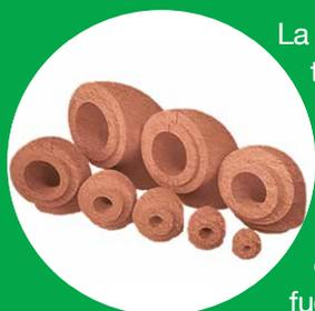
La resina fenolica è un materiale termoindurente che offre eccellenti proprietà meccaniche. Il range operativo va dai -180°C ai +120°C. Ha un elevato potere isolante, dovuto alla bassissima conducibilità termica, Reaz. al fuoco (Euroclasse C s1 do).
