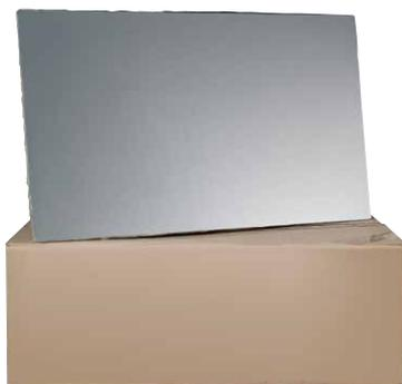
Pannello rigido in lana di roccia a medio-alta densità, rivestito su un lato con un film in alluminio per l'isolamento termico ed acustico. **Firerock** è incombustibile ed è stato studiato per l'isolamento termico delle cappe dei caminetti a legna. Il pannello isolante dovrà essere posato con la superficie rivestita con il foglio di alluminio rivolta verso la canna fumaria.
