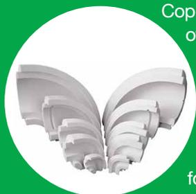
Coppelle in EPS in densità 20 kg/mc., ottenute da blocco, a celle chiuse, con reazione al fuoco classe E, Temperatura massima di utilizzo: 85°. Le coppelle possono essere realizzate a bordo dritto o con battente che impedisce la formazione di condensa quando vengono utilizzate per l'isolamento di tubi freddi. La precisione del taglio rende facile e veloce l'applicazione della coppella, evitando l'uso di colle.
