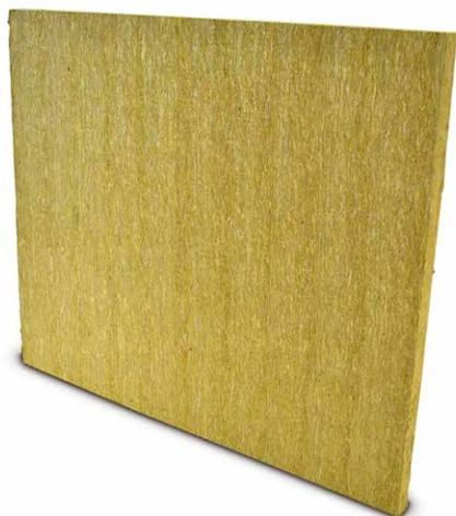
**Pannelli in lana di roccia** monolitici con orientamento delle fibre in verticale. Questo particolare processo produttivo consente di avere pannelli isolanti che rispondono alle esigenze di tutte quelle applicazioni dove sia richiesta alta resistenza alle compressioni, incollaggio tenace di strati di finitura e conseguente resistenza a trazione di questi ultimi (lamiere, laminati plastici, legno etc.)
