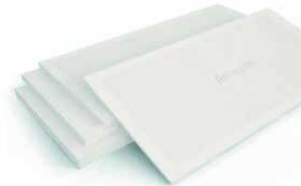
**Aeropan** è un pannello di nuova concezione, pensato per la realizzazione di isolamenti termici a basso spessore, composto da un isolante nanotecnologico in **Aerogel accoppiato ad una cialda traspirante in polipropilene, armata con fibra di vetro**. Aeropan è idoneo ad accogliere direttamente la rasatura armata per realizzare sistemi a cappotto termico, sia interno che esterno.
