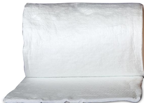
**Superwool Plus** è un materassino FVAT di colore bianco costituito da fibre lunghe agugliate su entrambi i lati e grazie ad un sistema di fibraggio che consente l'eliminazione del materiale non fibrato è stata ridotta la polverosità ed aumentata la resistenza alla trazione prima e dopo il riscaldamento.
