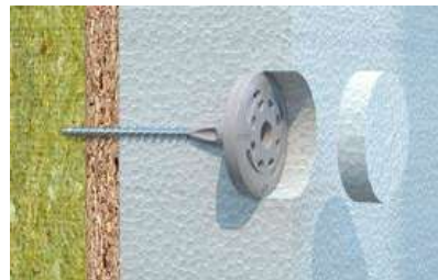
Fissaggio di pannello isolante in polistirene su pannelli in OSB.
