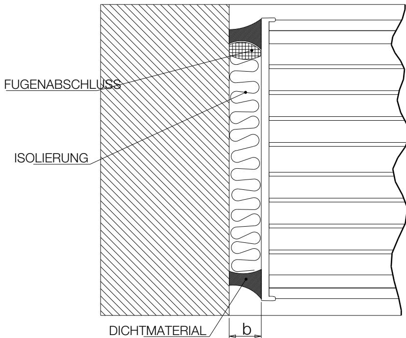
Largeur minimum du joint « b » pour une substance isolante injectée
