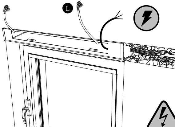
Deve essere previsto nella rete di alimentazione un dispositivo che assicuri la disconnessione dalla rete onnipolare, con una distanza di apertura dei contatti che consenta la disconnessione completa nelle condizioni della categoria di sovratensione III.
