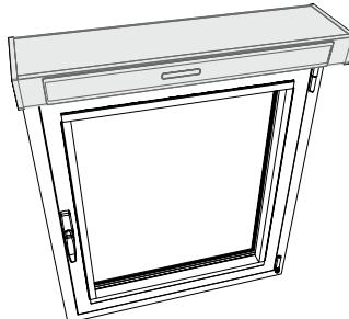
Installazione da incasso - montaggio orizzontale
