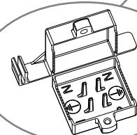
Assicurarsi di isolare il secondo terminale non utilizzato con l'apposita protezione.
